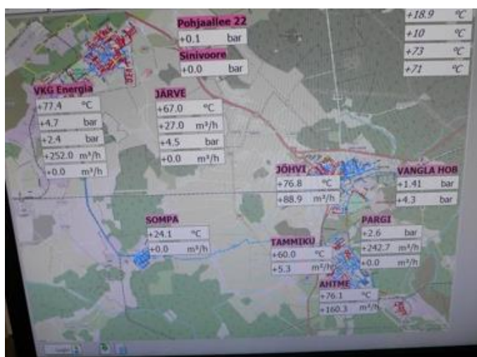
Joonis 3.1 Ahtme reservkatlamaja ja katlaruumi sisevaated ning kaugküttesüsteemi andmete kuva arvutiekraanil. Fotod V. Vares
